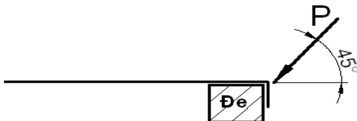
Hình 2B.2: Gấp mép L=5
