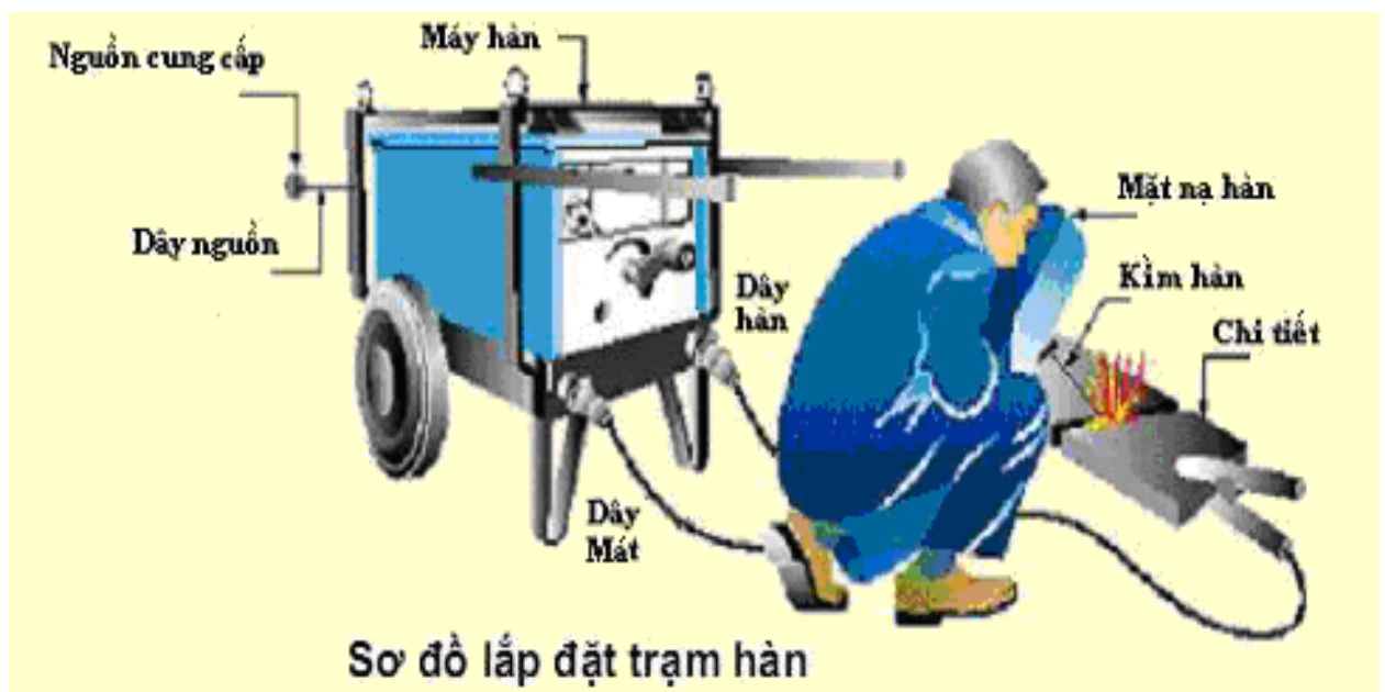
Hình 16.1: Sơ đồ lắp đặt trạm hàn
