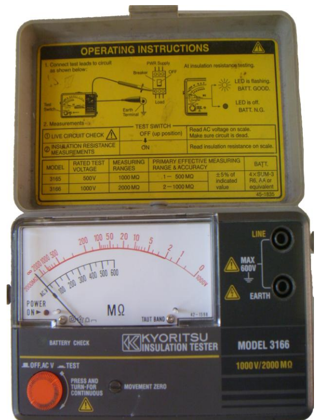
Hình 1.3. Mê gôm mét Model 3166 đo điện trở các điện thiết bị điện hạ áp
