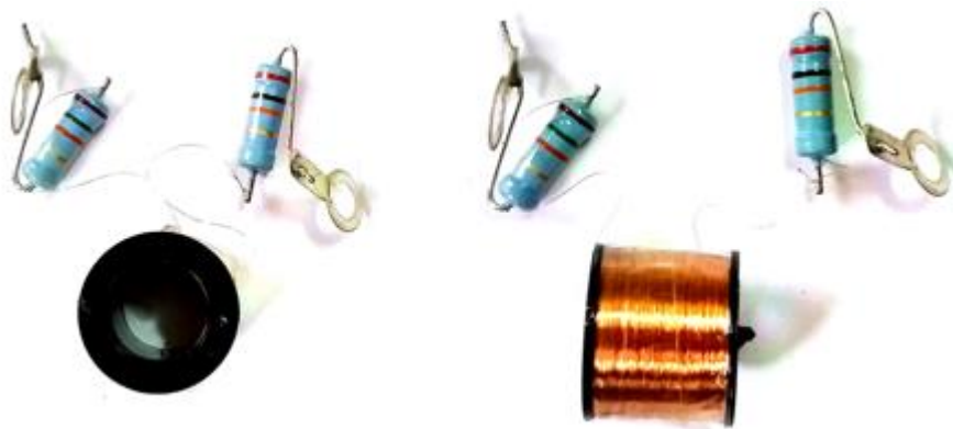
Hình 2-11: Cuộn dây Vôn mét cơ
