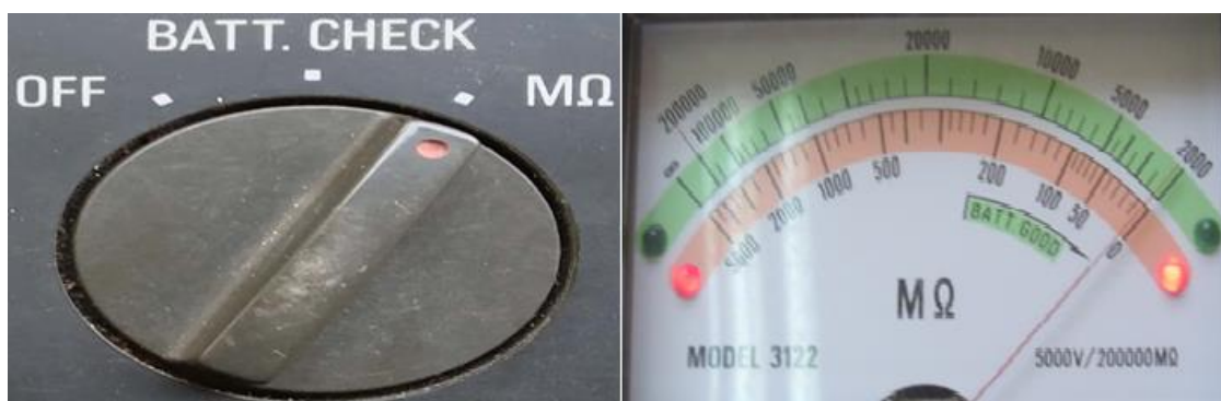
Hình 6-18: Kiểm tra ngắn mạch mê gôm mét 3122
