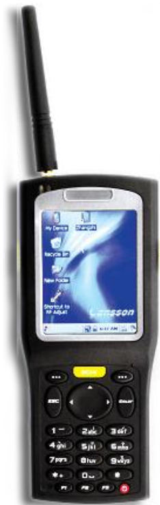
Hình 4-41: Thiết bị ghi chỉ số công tơ cầm tay HHU
