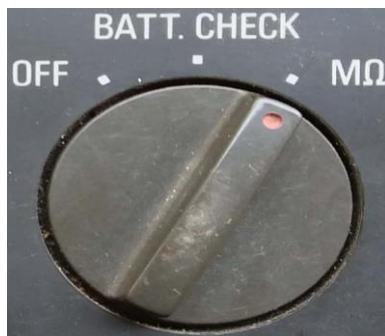
Hình 6-17: Kiểm tra hở mạch mê gôm mét 3122
