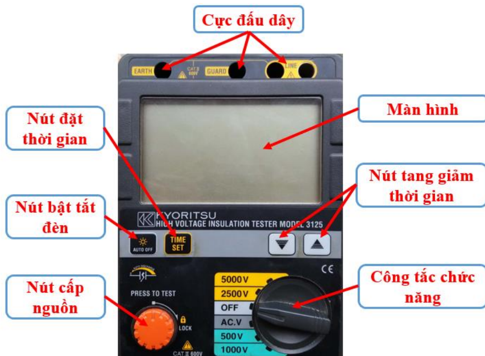
Hình 6-19: Cấu tạo bên ngoài mê gôm mét 3125
