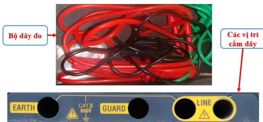
Hình 6-20: Bộ dây đấu mê gôm mét 3125
