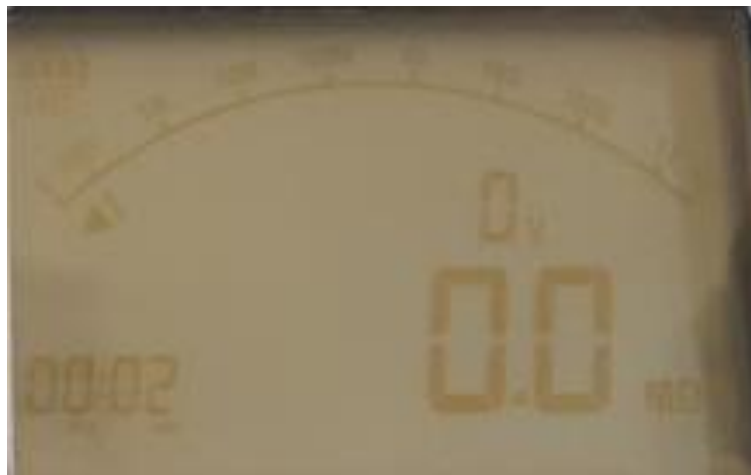
Hình 6-23: Kiểm tra ngắn mạch mê gôm mét 3125
