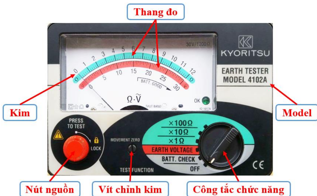
Hình 6-1: Cấu tạo bên ngoài tê rô mét 4012A
