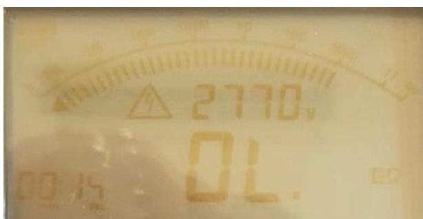
Hình 6-22: Kiểm tra hở mạch mê gôm mét 3125
