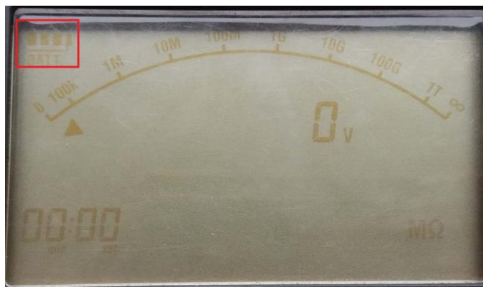
Hình 6-21: Kiểm tra pin mê gôm mét 3125
