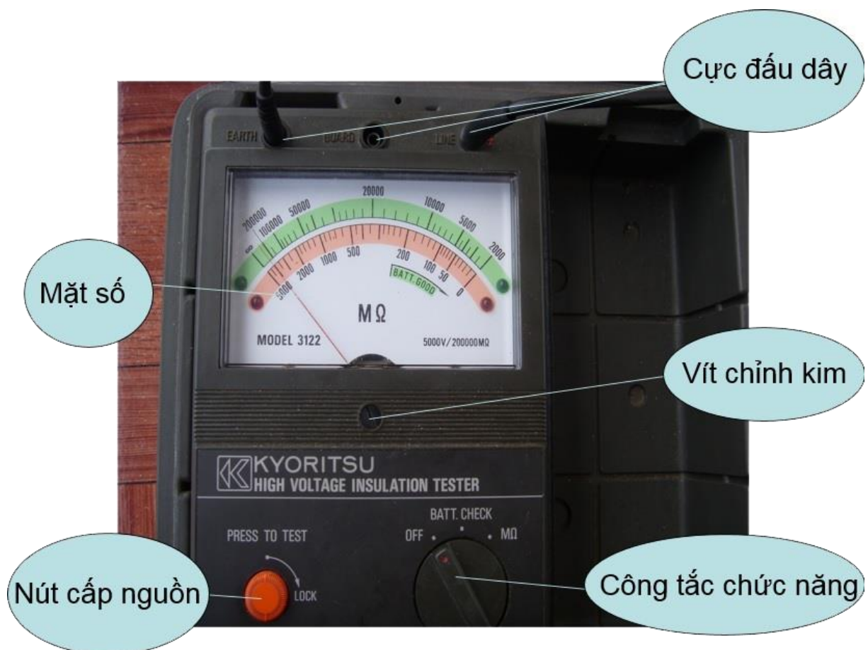
Hình 6-14: Cấu tạo bên ngoài mê gôm mét 3122
