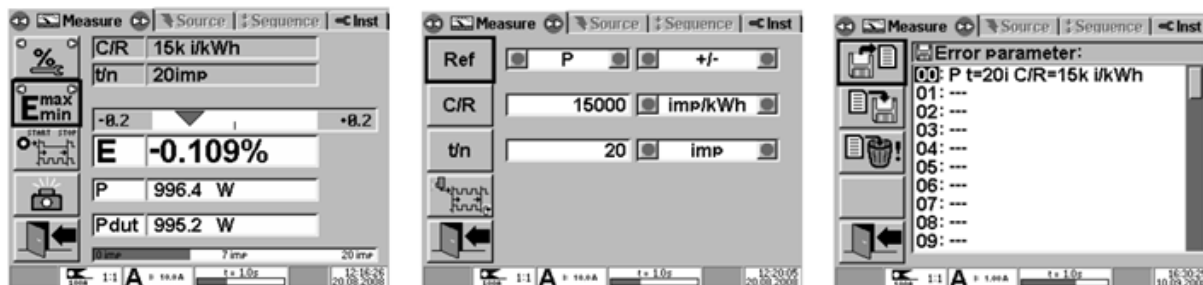
Hình 4-23: Chức năng kiểm công tơ
