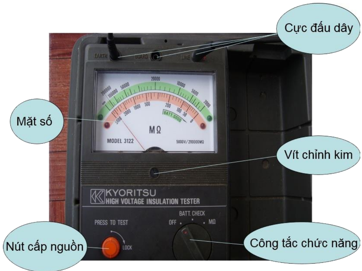
Hình 6-14: Cấu tạo bên ngoài mê gôm mét 3122
