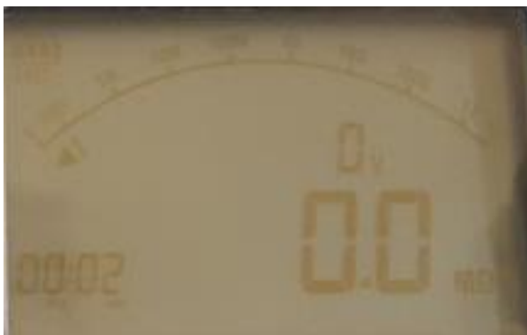
Hình 6-23: Kiểm tra ngắn mạch mê gôm mét 3125
