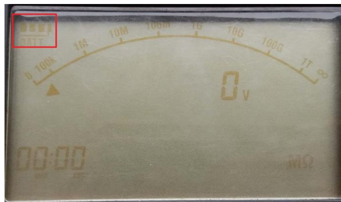
Hình 6-21: Kiểm tra pin mê gôm mét 3125
