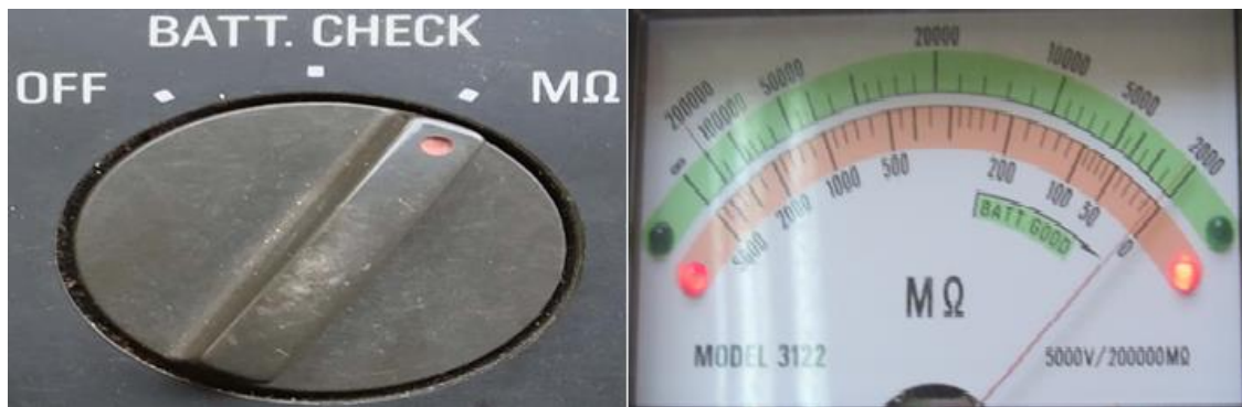
Hình 6-18: Kiểm tra ngắn mạch mê gôm mét 3122
