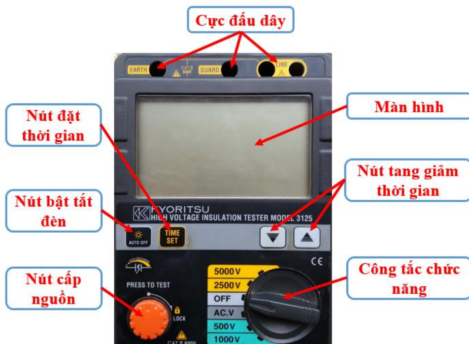
Hình 6-19: Cấu tạo bên ngoài mê gôm mét 3125
