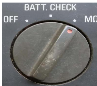
Hình 6-17: Kiểm tra hở mạch mê gôm mét 3122
