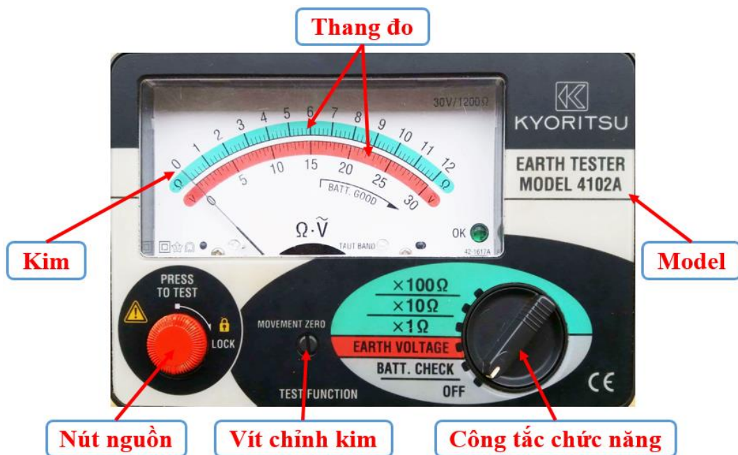
Hình 6-1: Cấu tạo bên ngoài tê rô mét 4102A
