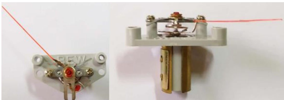
Hình 2-10: Cơ cấu đo Vôn mét cơ
