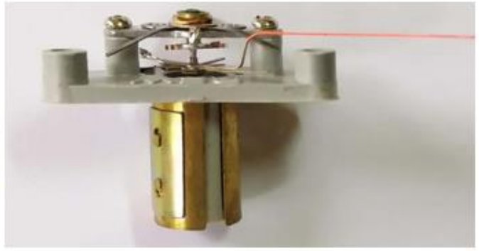
Hình 2-6: Cơ cấu đo Ampe mét cơ
