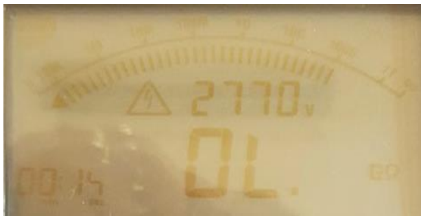
Hình 6-22: Kiểm tra hở mạch mê gôm mét 3125
